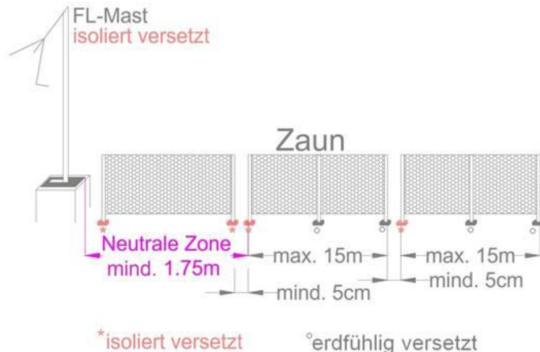
Abbildung 2: Skizze isolierte Montage von Zäunen
